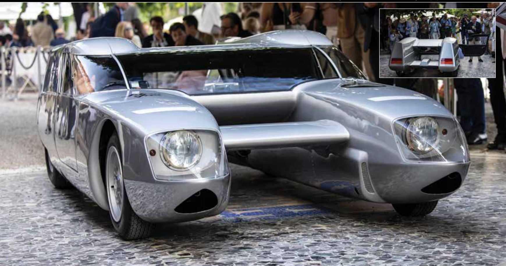
OSI Bisiluro - италианска машина от 1967, построена за 24-те часа на Льо Ман. Завива от едномитров мотор от Renault Alpine, монтиран отляво, за да балансира тежлото на шофьора, който седи в дясната част. Максималната скорост е 251 км/ч OSI Bisiluro - an Italian machine from 1967, built for the 24 Hours of Le Mans. Powered by a one-liter Renault Alpine engine, mounted on the left to balance the weight of the driver, who sits on the right. Top speed is 251 km/h
